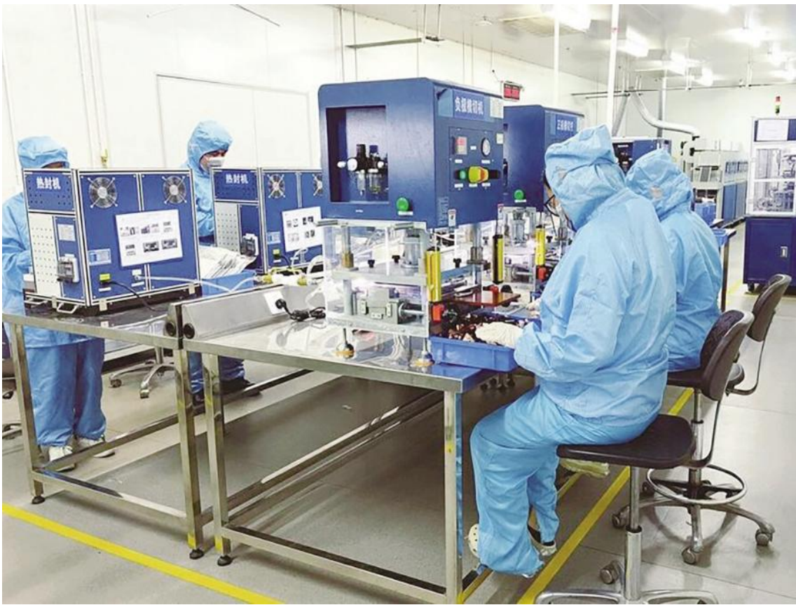
生产车间内,工作人员正在生产超级电容器。图为模切极片操作环节。 ■ 李晶晶摄
