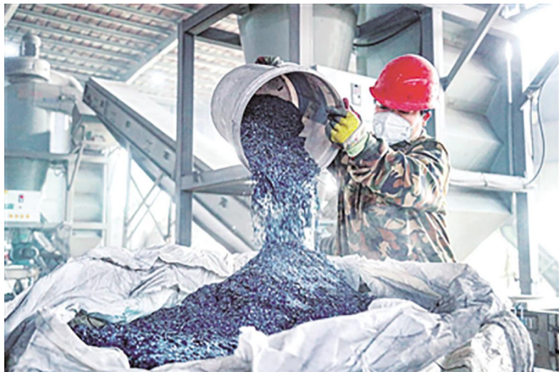
工人收集光伏组件破碎后的颗粒。■ 张泽慧摄
