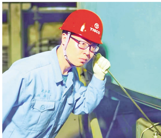
赵宇星正在用听音棒对设备进行故障排查 图片由受访者提供
