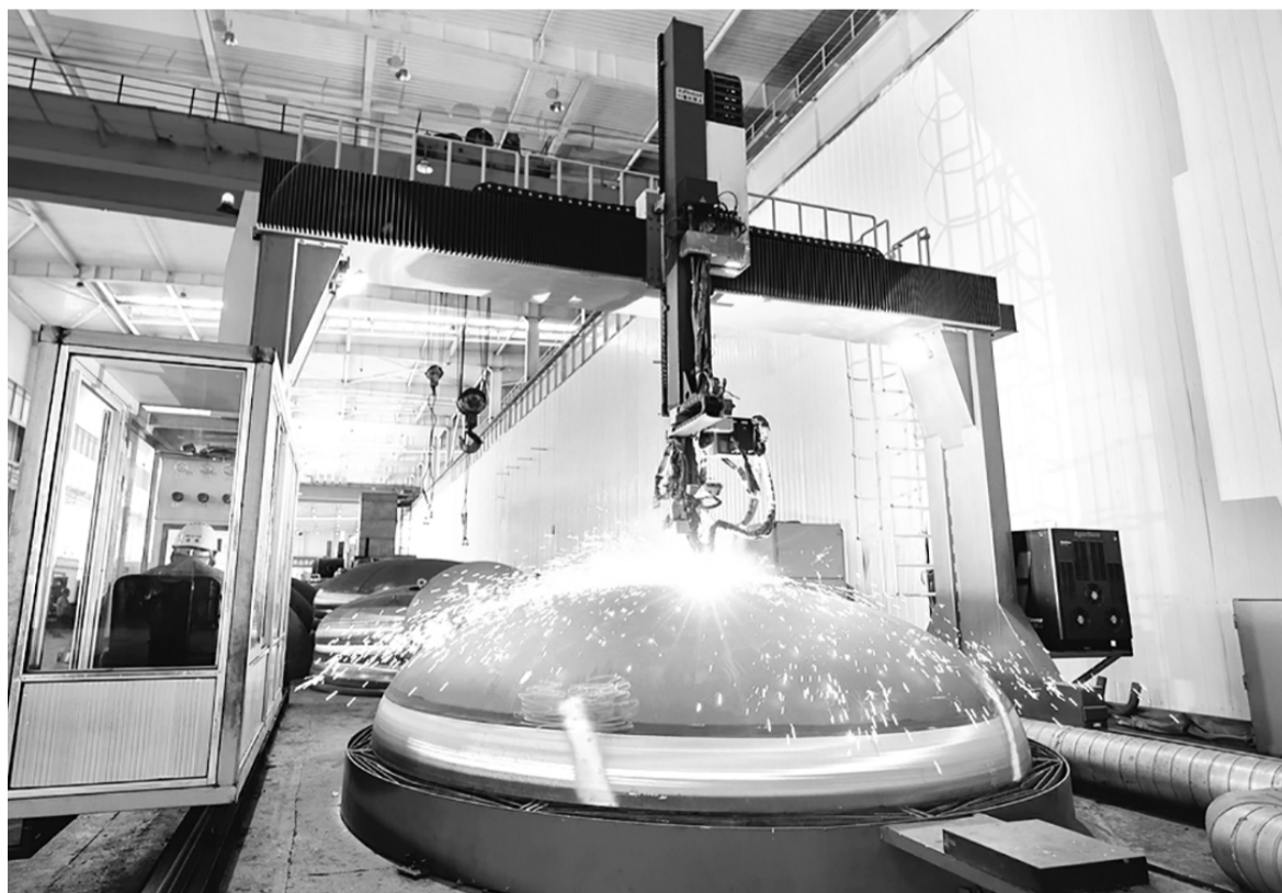
近年来，潞安化工机械(集团)有限公司大力推行智能制造，通过引进大量“机器人”装备，向国家领航级智能工厂、零碳工厂不断迈进。图为5月7日拍摄的潞安化工材料加工分公司龙门式智能数控封头切割机开孔场景。 陈阳摄
