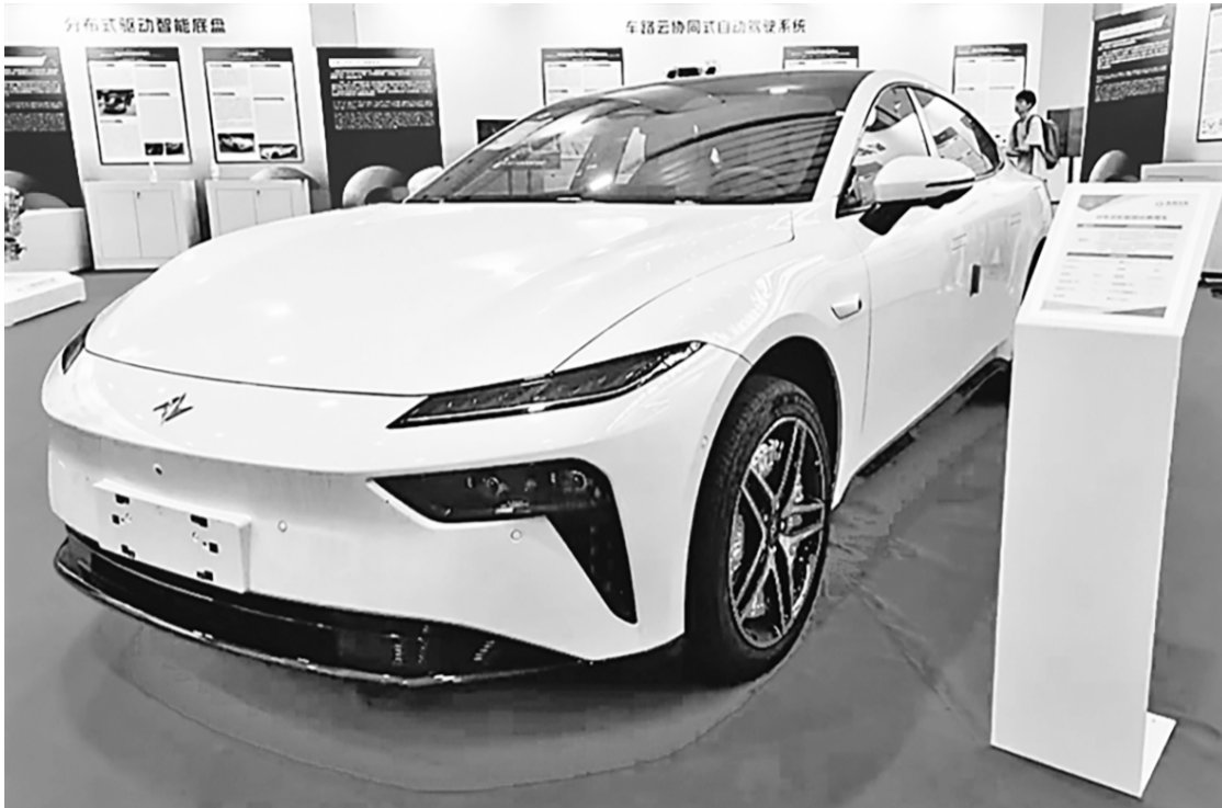
搭载了全国首款轮毂电机量产乘用车——“东风奕派007” 受访单位供图
