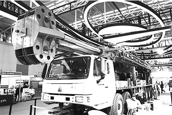
T138 柔性自适应双动力头车载钻机 ■ 陈曦摄
