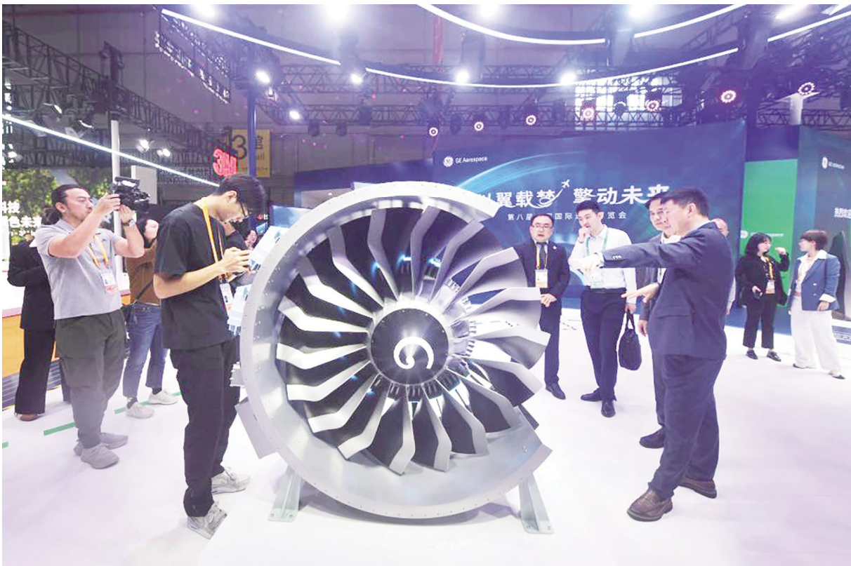
在第八届中国国际进口博览会上,通用电气(GE)航空航天在国内首次对公众展出 C919 飞机的动力“心脏”——LEAP-1C 发动机 1:2 剖面模型。该模型以真机尺寸的 50% 比例制作,通过剖面形式展现风扇、涡轮、转子、燃烧室、尾喷管等内部结构,参观者可近距离“一探究竟”。 据了解,LEAP-1C 发动机是国产 C919 客机目前使用唯一使用航空发动机,未来随着国产民用航空发动机长江-1000A(CJ-1000A)投入使用,C919 的航空发动机采用将更为丰富。 ■ 视觉中国
