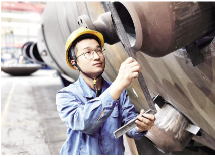
测量气化炉壳体接管管口
