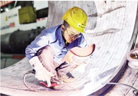
打磨气化炉壳体接管
