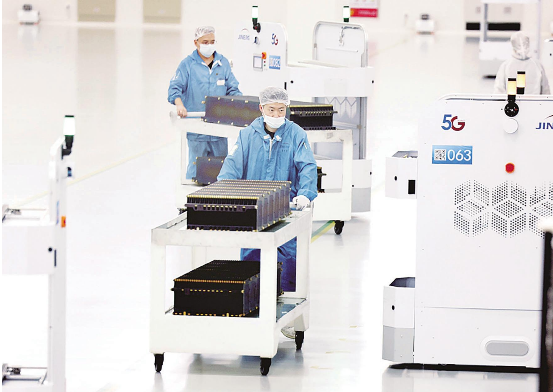
晋能光伏技术有限公司电池智能制造车间内,技术人员正在转运清洗完成的石墨舟载具。■ 韩乐摄
