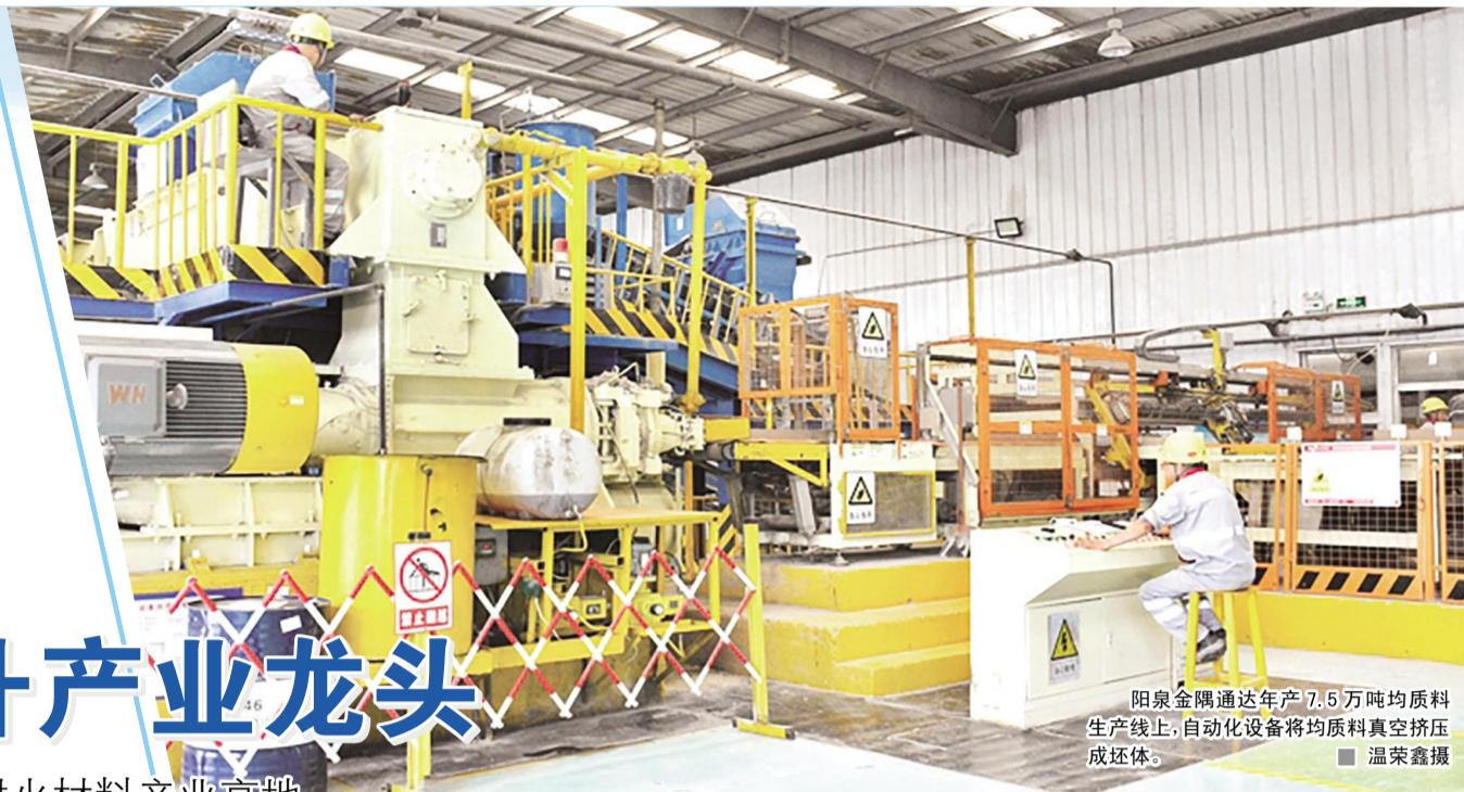
阳泉金隅通达年产7.5万吨均质料生产线上,自动化设备将均质料真空挤压成坯体。 ■ 温荣鑫摄
