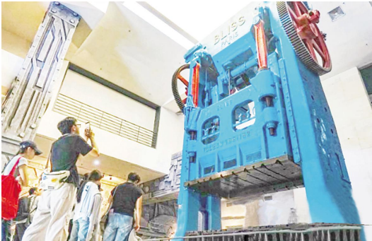
9 月 7 日,在广西柳州工业博物馆,游客在参观 20 世纪 80 年代柳州微型汽车厂从法国引进、用于汽车大型冲压件生产双动压力机。
