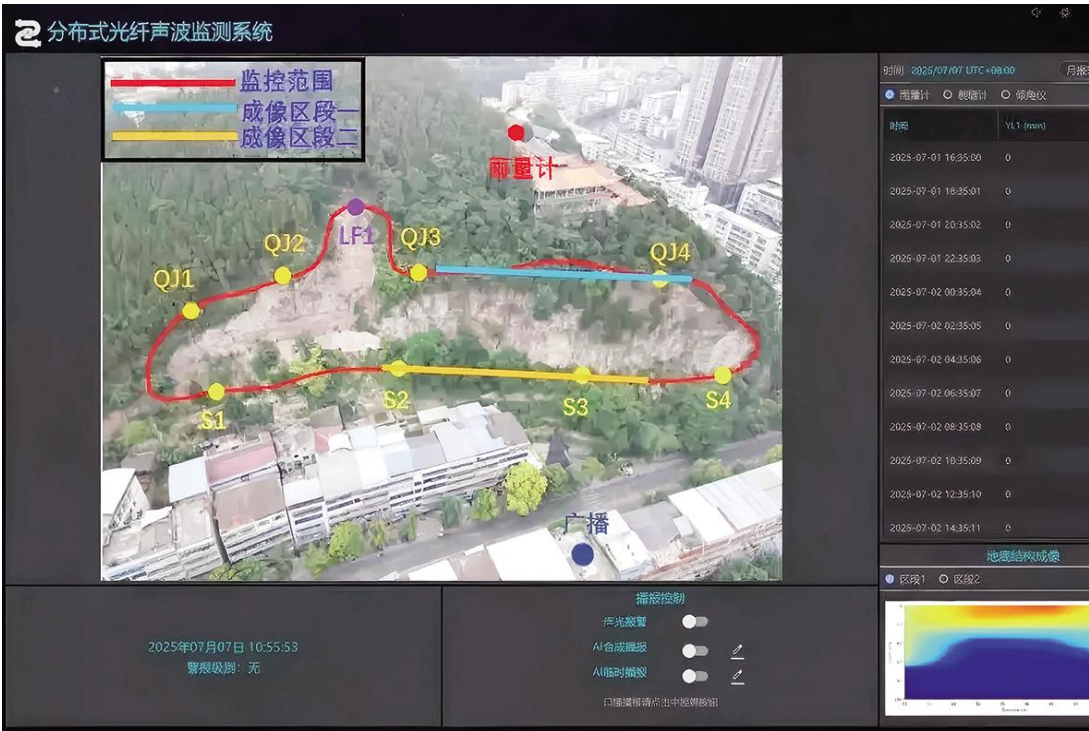
分布式光纤声波传感系统在运行中。 资料图
