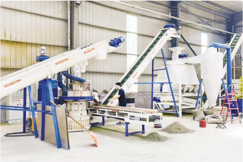
稷山县飞云秸秆综合利用专业合作社的秸秆颗粒生产线。■ 图片由受访者提供
