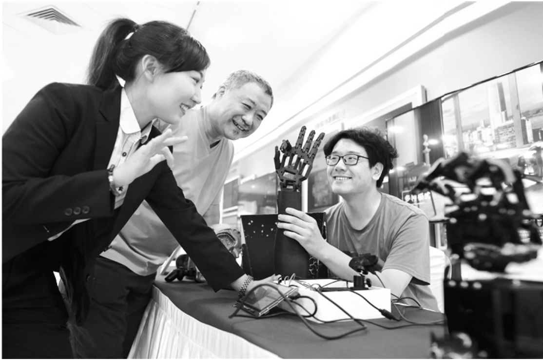
7 月 2 日，观众在第二十七届中国科协年会展览展示与场景体验区，参与家庭陪伴机器人灵巧手互动体验。该人形机器人的灵巧手有 14 个自由度，可以负载 20 公斤，模仿人类的手部动作，也能连接大模型进行运动控制和学习。 ■ 季春红摄
