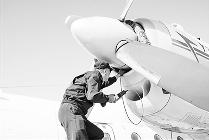
官兵利用电子测量仪对战鹰故障进行检测 ■ 李小伟摄
