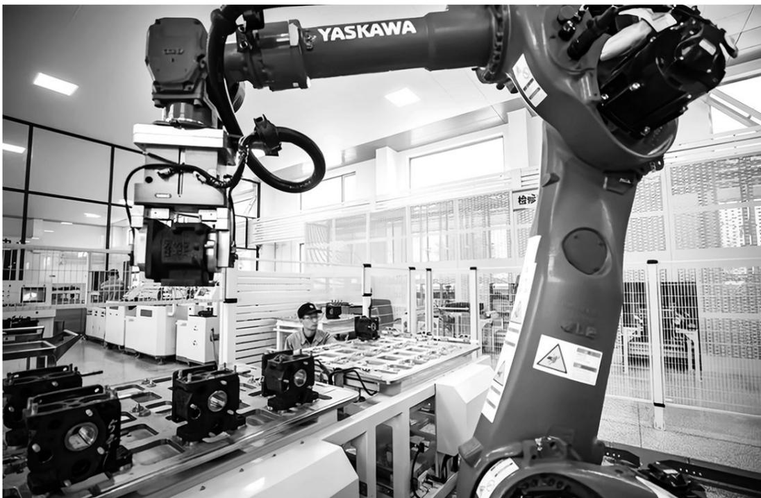
3月9日,在中国铁路太原局集团湖东车辆段重载智能检修中心,技术人员正在操作刚刚全新升级的AMR(轮对分拣、检修装置)。湖东车辆段建立轮对自动检修中心,构建了制动阀检修数字化和轮对二修级数字化系统,在“机器人工友”的加持下,故障识别速度持续升级,相较以往人工操作,提高了70%的效率,筑起保障大秦铁路重载运输安全的高科技防线。 科学导报记者刘娜摄
