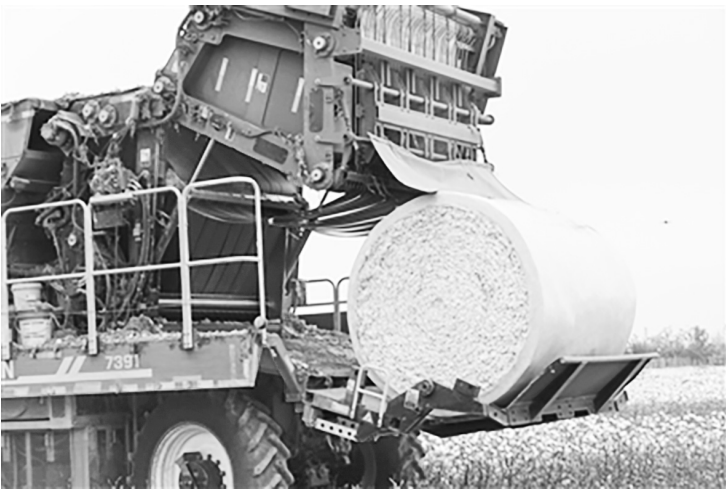
在新疆一处棉田，大型采棉机卸下自动打包好的棉花
