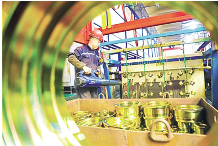
阳泉市天昊再生资源回收有限公司一期项目于今年建成投产，项目建有国内领先的污水处理车间及废气回收系统，全方位实现生产环节及末端环保零排放。目前，二期项目正在加紧施工，首台25吨室内龙门吊已安装调试到位，并展开了大型液压支架的整架维修。图为工人给矿用导向套镀金。■张泽慧摄
