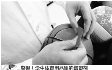
检测人员对球类产品的增塑剂含量进行检测
