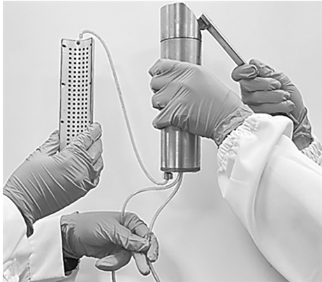
手压式便携式海水淡化装置 ■ 受访单位供图
