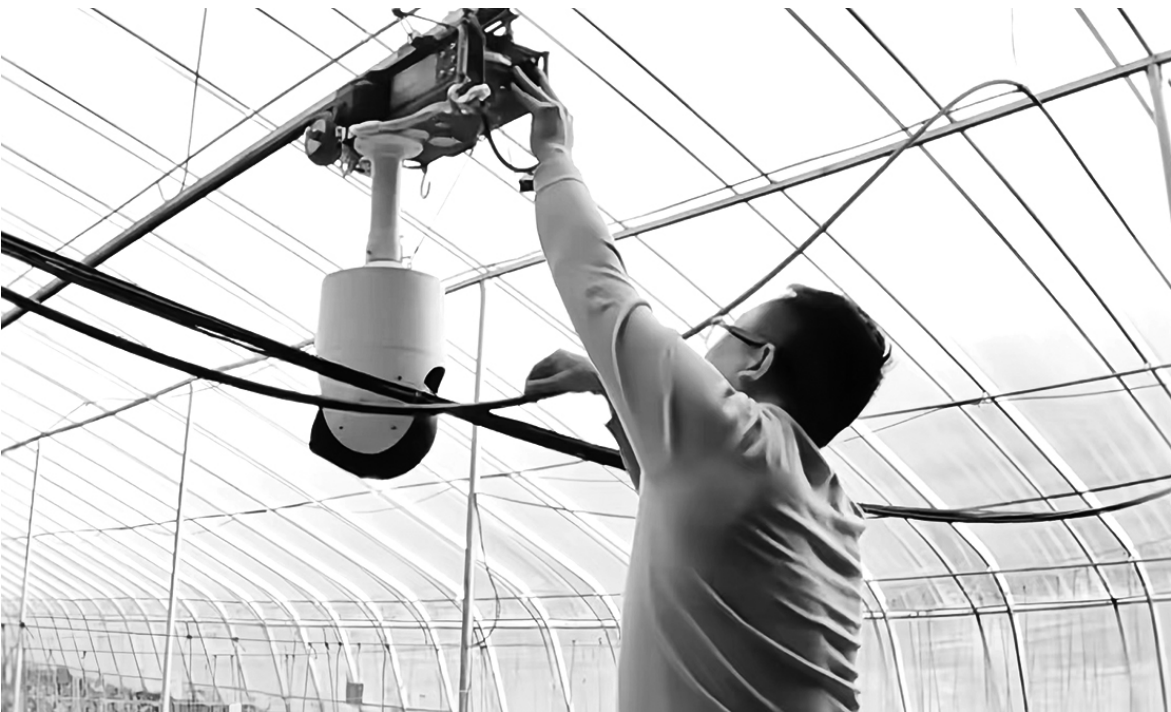
11 月 27 日,临汾市曲沃县史村镇张范村第六代新型智能温室大棚里,山西远臻农业发展有限公司研发的“大棚巡检机器人”正在工作。据了解,该机器人可以通过拍摄棚内蔬菜,结合公司研发“病虫害大模型”小程序进行快速识别判断出蔬菜健康情况,准确率可达 93% 以上。“大棚巡检机器人”的入驻是 AI 和农业结合的一种创新模式,既能节约人工成本,又能减少因无法准确判断病虫害而带来的损失,更为蔬菜大棚增添了十足的“科技范”。■ 科学导报记者刘娜 通讯员王磊摄影报道
