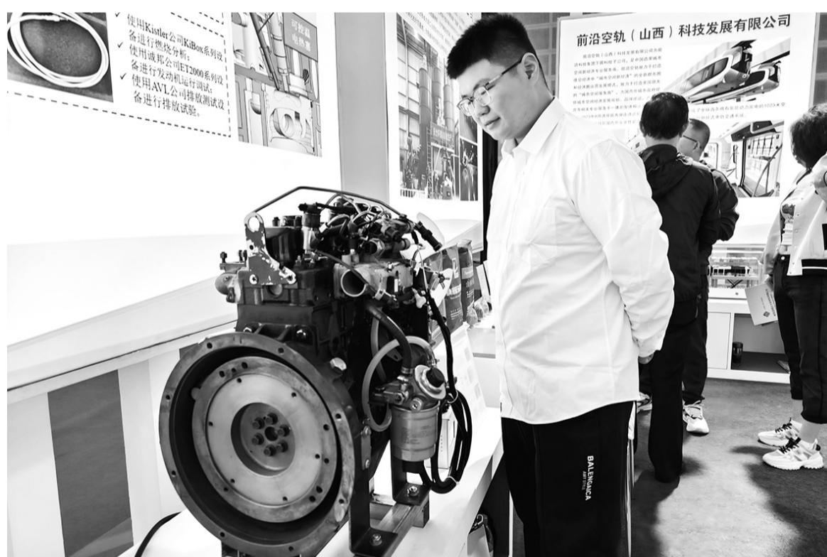
9月10日,在2024年太原能源低碳论坛科技成果展览现场,一台别样的发动机引人注目。据了解,这是一台电热塞辅助压燃甲醇发动机,是太原理工大学机械学院车辆工程系课题组攻关项目,其具有良好的动力性、经济性及排放性。攻关中,对于喷油及供油系统的改造解决了传统压燃发动机在冷启动和低温环境下点火困难的问题。期间,多燃烧模式下喷射参数的研究可以有效改善甲醇发动机在各负荷下的燃烧稳定及运行状态问题。
