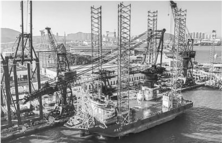
“第四代+”海上风电施工平台“港航平 5” ■ 受访单位供图
