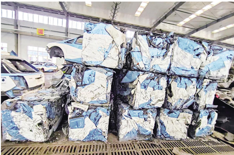
经过精细化拆解后,车体最后被压缩成方形铁块。
