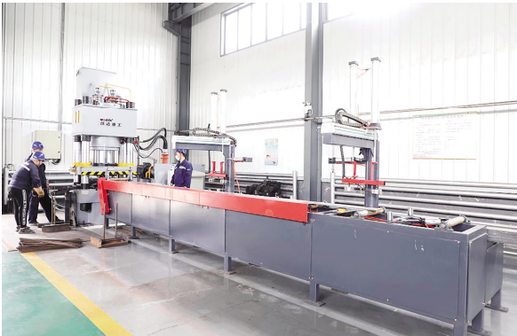
轩岗煤电实业公司车间工人正在操作500吨矿用锚杆托盘成型液压机 ■ 受访者供图
