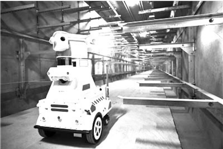
图为巡检机器人在地下综合管廊内进行技术调试。
