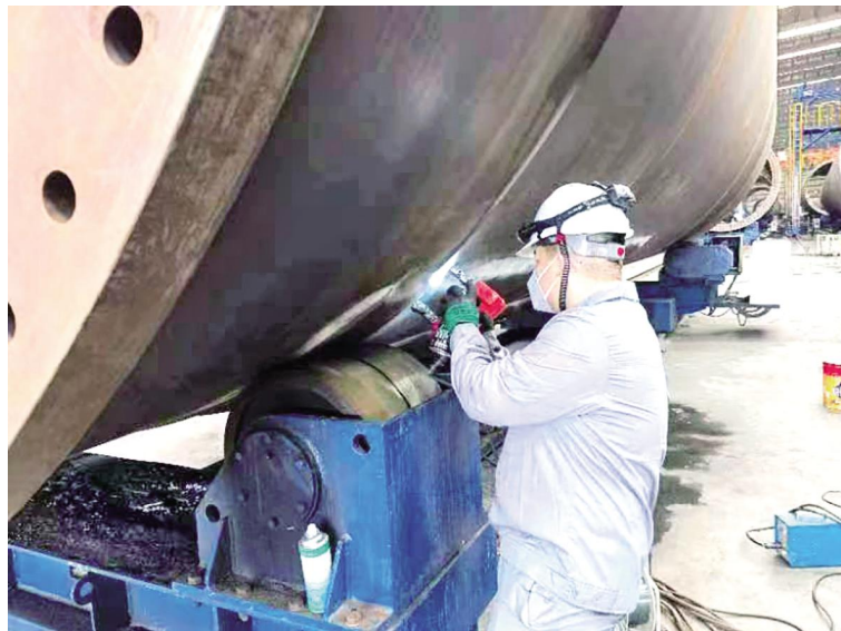
技术人员李若抒正在进行风电塔筒焊缝无损检测工作
