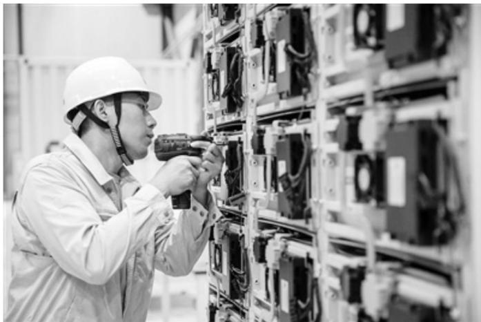
图为工人组装电化学储能装置。电化学储能是可满足长时储能技术需求的储能技术之一。 ■ 视觉中国供图
