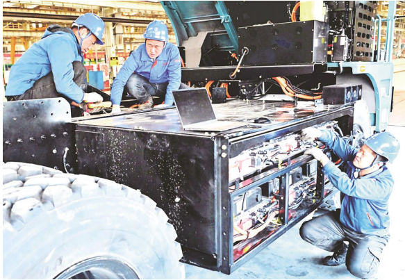
10月29日,在大同经济技术开发区陕汽大同专用汽车有限公司装配车间,工人们正在安装调试电动矿用卡车电池组。近年来,陕汽大同依托集团技术力量对新能源产品不断开发完善并逐步量产达效。今年9月通过技改开发90吨、105吨宽体电动矿用卡车已投入试制,助力我省绿色矿山低碳减排。■王中勋 摄
