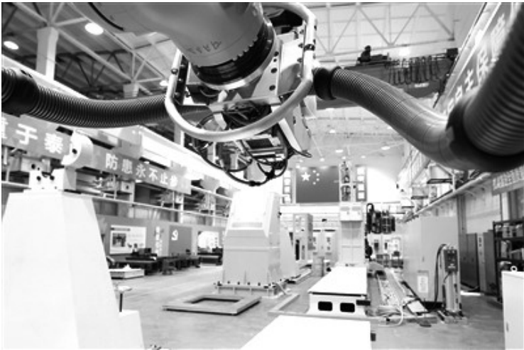
图为机器人式自动铺丝机。■ 受访单位供图
