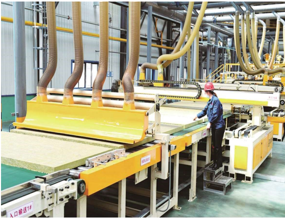
7月4日,山西威世腾岩棉有限公司工人正在自动化生产线生产岩棉产品。晋山县统筹推进传统产业改造提升与新兴产业培育发展,围绕精细化工、合金材料、纸包装、碳基新材料、废弃资源循环利用等产业建设自动化、智能化生产线,推动传统优势产业技术改造和生产线优化升级,实现集约化发展。 ■栗卢建 摄
